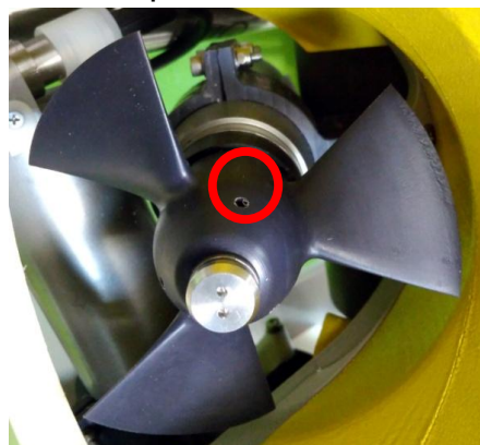
Рисунок 9 – Гребной винт – отверстие для смазки
